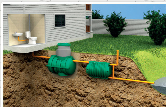
Схема подключения АК «Rostok» для использования только в теплое время года.
