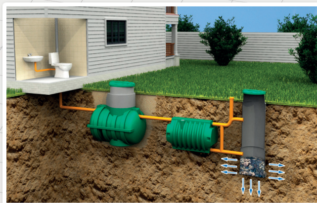
Схема подключения АК «Rostok» для использования только в теплое время года.
