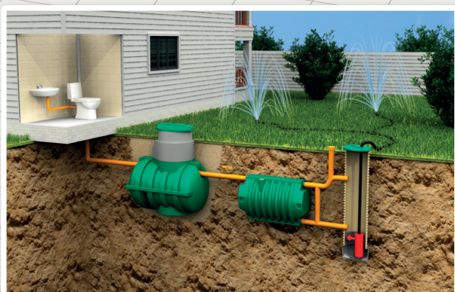
Схема подключения АК «Rostok» для использования только в теплое время года.
