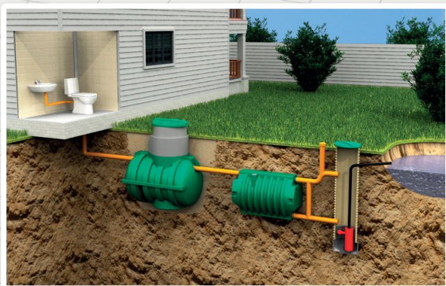
Схема подключения АК «Rostok» для использования только в теплое время года.
