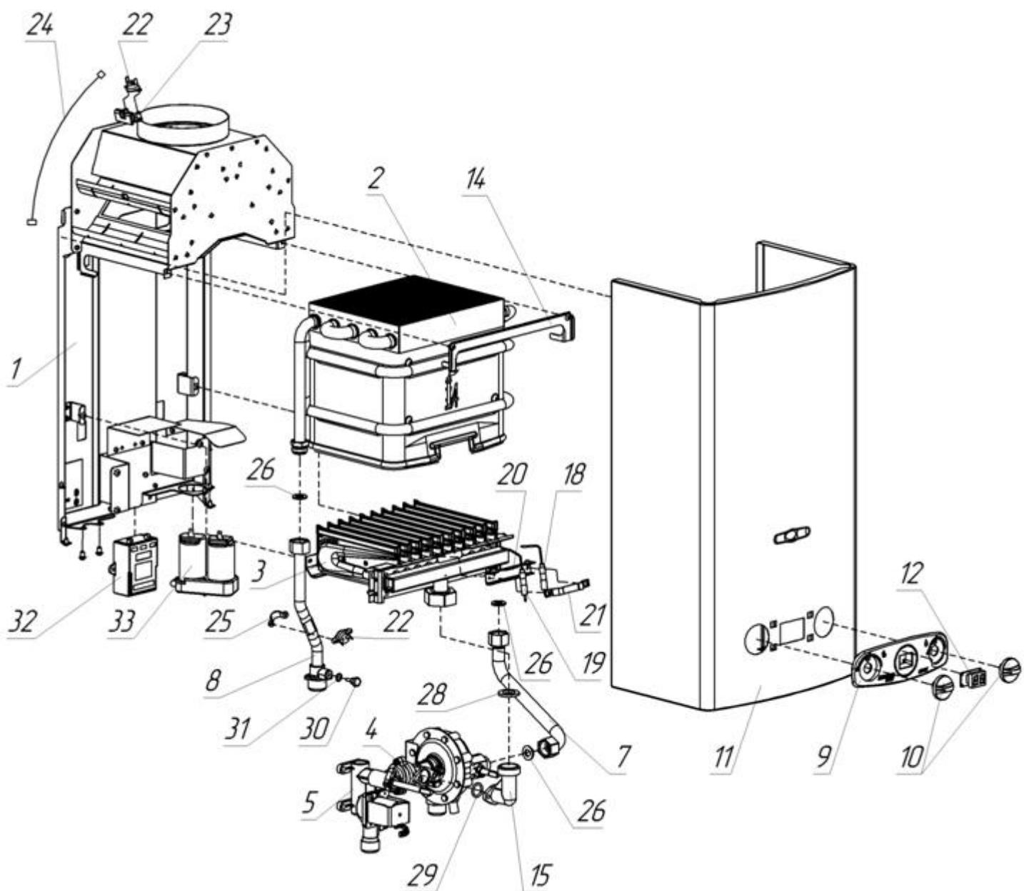
Рисунок 18. Вид аппарата «NEVALUX-5611» с разнесёнными частями
