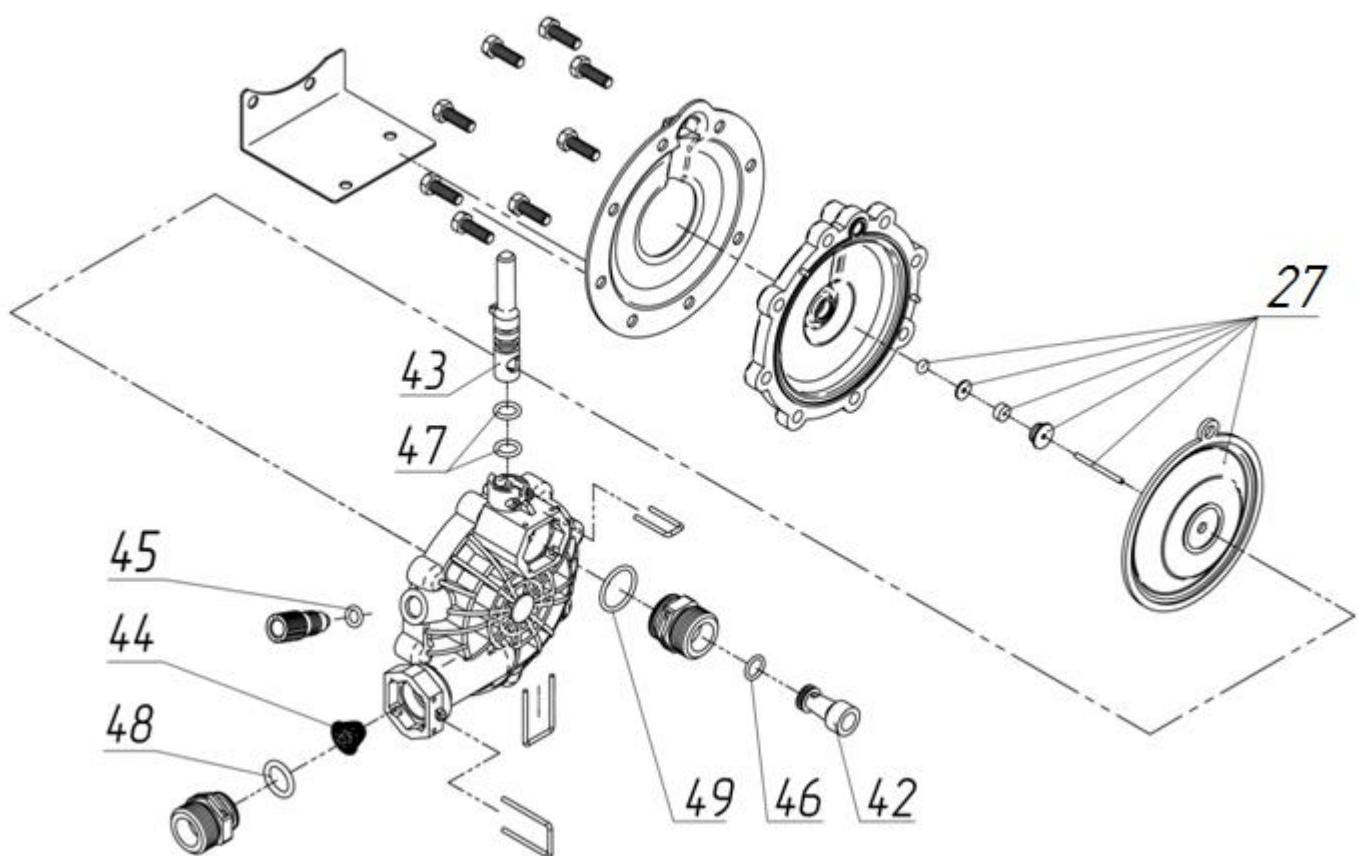
Рисунок 20. Составные части узла водяного STG-W4P1
