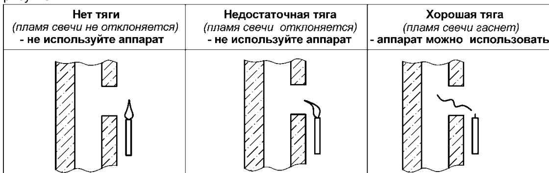
Рисунок 7. Способ проверки тяги в дымоходе
