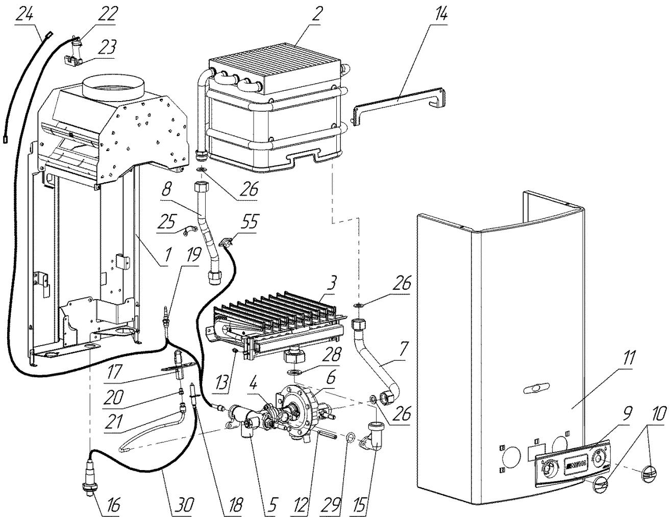
**Рисунок 16. Вид аппарата «NEVALUX-5111» с разнесёнными частями**
