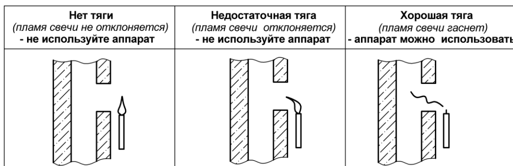
Рис. 4. Способ проверки тяги в дымоходе
