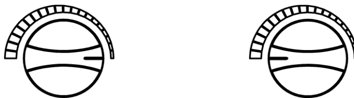
а) Ручка крана расхода газа в положении “Минимальный расход” б) Ручка крана расхода газа в положении “Максимальный расход”
