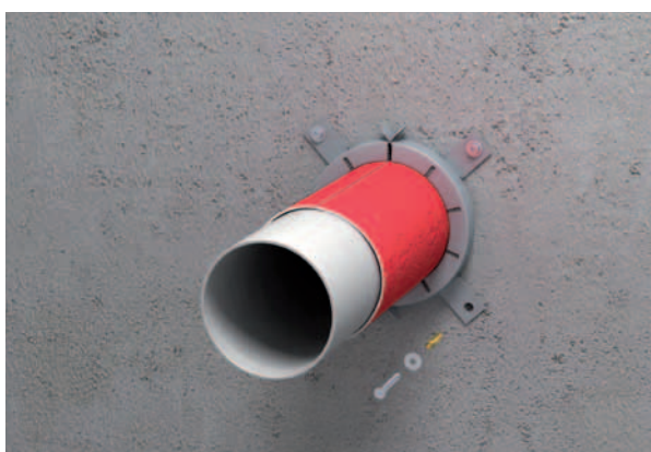
Закрепите планки винтами с дюбелями, используя прилагаемый крепежный набор (как вариант, планки можно согнуть на 90° и заделать в раствор!)
