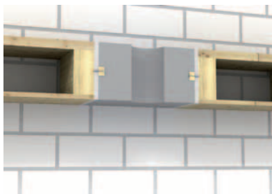
Перекрытие с деревянными балками без подшивного потолка
