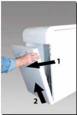
рис. 5 - Открытие передней панели.
