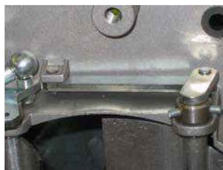
Vedere clapetă dreapta blocată
