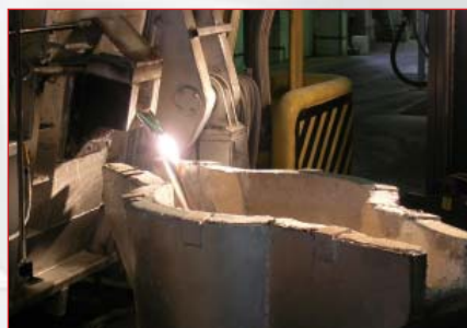
Разливка алюминия из плавильной печи
