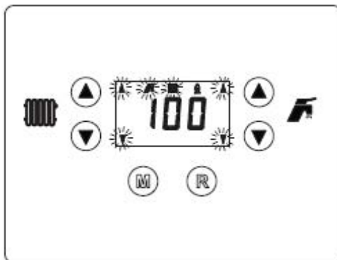
Рис. 17 – Режим ТЕСТ (мощность отопления – 100%)
