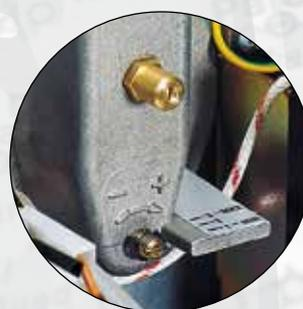
Регулировка головки горения
