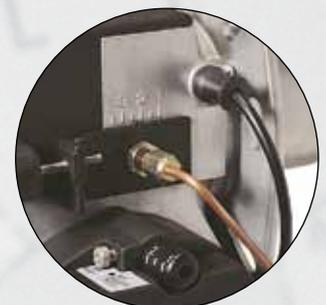
Регулировка воздуха и головки горения
