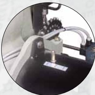
Регулировка головки горения
