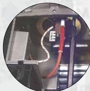
Регулировка головки горения
