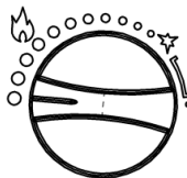
Рисунок 3. Положения ручки регулировки расхода газа аппарата «NEVA-4011»
