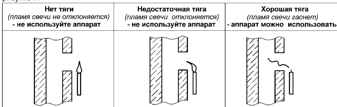
Рисунок 7. Способ проверки тяги в дымоходе
