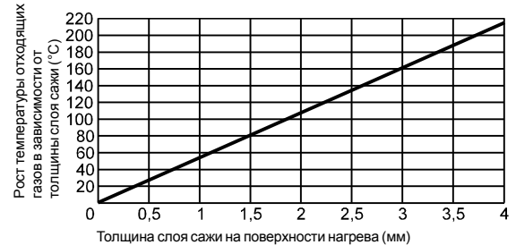
Рис. 4: Возрастание температуры отходящих газов в зависимости от толщины слоя сажи
