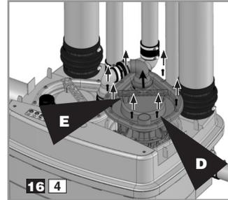
Irrota huoltoluukun ruuvit D. Käytä vedintä E moottorin nostamiseksi.
