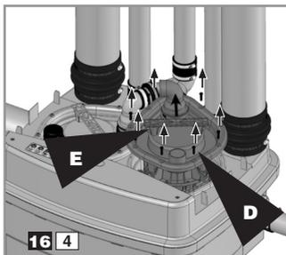
Deșurubați șuruburile **D** ale capacului. Folosiți mânerul **E** pentru a ridica motorul cu grijă.
