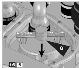
Umístěte víko motoru zpět na jeho místo ve stanici a přišroubujte ho šrouby **D**. Opět připojte výstup ke zpětnému ventilu a zajistěte sponou **A**. Použijte ucpávku **G** na zaslepení průchodu kabelu motoru ve víku motoru. Upevněte sponou **B**.
