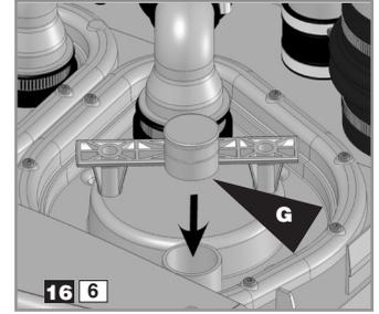
Aseta huoltoluukku takaisin paikoilleen. Kytke poistoputki takaisin paikoilleen. Käytä tulppaa G moottorin virtajohdon aukon peittämiseen huoltoluukussa. Laita letkunkiristin B paikoilleen.
