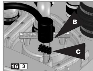
Dévisser le collier **B**. Débrancher les fils moteurs du bornier **C**.
