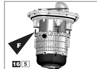
Jos viallinen moottori on palautettu valmistajalle, pumppuasemaa voidaan käyttää vähimmäiskokoonpanossa vain yhden moottorin varassa. Irrota viallisen moottorin huoltoluukun ruuvit F
