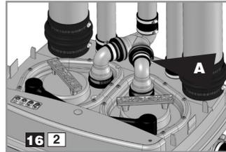
Odkręć pierścień **A** uszkodzonego silnika (podczas naprawy silnika zawór zwrotny pozostaje na swoim miejscu).
