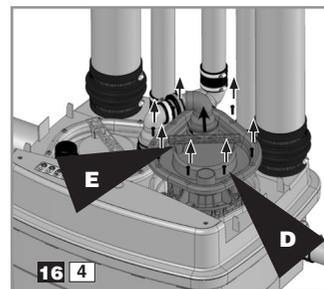
Dévisser les vis **D** de la trappe. Utiliser la poignée **E** pour soulever le moteur avec précaution.
