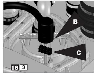
Schroef slangklem **B** los. Maak de motorbedrading los van het kroonsteentje **C**.
