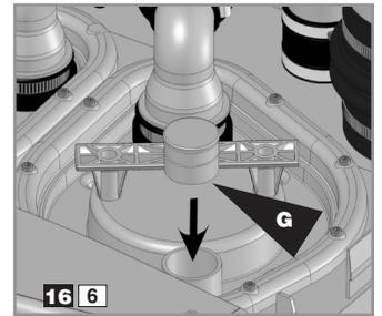
重新装上翻板活门。再次连上排水管。使用塞子G堵上翻板活门马达的出线口。用套环B固定。
