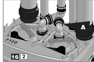
Haal de kap los. Schroef slangklem **A** van de defecte motor los (de terugslagklep blijft op zijn plaats tijdens het herstellen van de motor).
