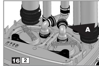
将护罩拆离。旋松故障马达上的套环A(止回阀在进行马达故障时始终位于原位)。
