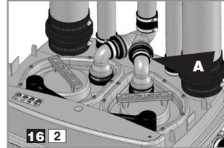
Снять зажимы с крышки мотора. Вывинтить кольцо **A** неисправного мотора (обратный клапан должен оставаться на месте в ходе починки мотора).
