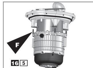
Pokud je třeba, aby byl porouchaný motor dopraven k výrobci, můžete nechat čerpadlo běžet v provizorním režimu s jedním motorem. Odšroubujte šrouby **F** porouchaného motoru z víka motoru.
