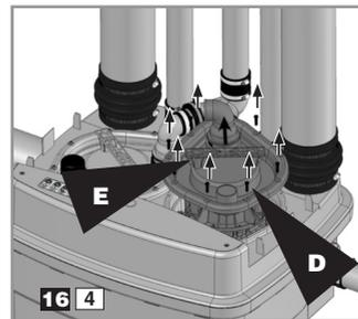
Draai de schroeven **D** van de kap los. Gebruik de handgreep **E** om de motor voorzichtig op te tillen.
