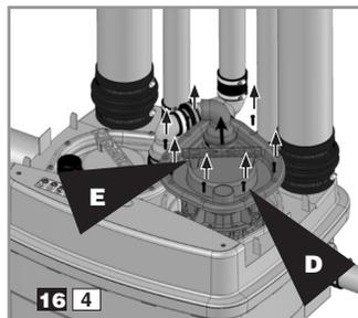
Odšroubujte šrouby **D** víka motoru. Opatrně nadzdvihněte motor za držadlo **E**.
