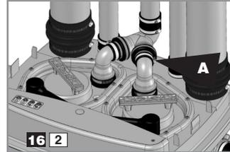
Lossa slangklämma **A** till den defekta motorn (backventilen ska sitta kvar på plats vid reparation av motorn).
