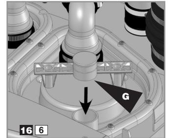
Założ klapę na miejsce. Podłącz odprowadzenie. Użyj zaślepki **G** do zamknięcia wyjścia przewód silnika z kłapy. Przymocuj opaski **B**.
