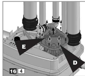
Lossa skruvarna **D** på locket. Använd handtag **E** för att försiktigt lyfta upp motorn.
