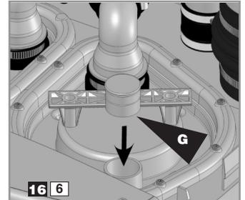
Sätt tillbaka locket. Anslut avloppet igen. Använd propp **G** för att täcka motorledningarnas utgång från luckan. Fäst med slangklämma **B**.
