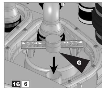
Coloque a tampa na devida posição. Ligar a evacuação. Utilizar a tampa **G** para vedar o acesso ao orifício dos fios do motor. Fixar com a abraçadeira **B**.
