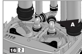
Déclipser le capot. Dévisser le collier **A** du moteur défectueux (le clapet anti-retour reste en position lors du dépannage du moteur).
