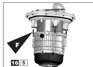
Si le moteur défectueux doit repartir chez le fabricant, vous pouvez laisser le releveur assurer un service minimum avec un seul moteur. Dévisser les vis **F** du moteur défectueux de la trappe.
