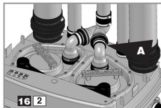
Sejměte kryt. Odšroubujte sponu **A** porouchaného motoru (zpětný ventil zůstává během demontáže motoru na svém místě).
