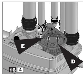
Odkręć śruby **D** kłapy. Ostrożnie podnieś silnik za pomocą uchwytu **E**.
