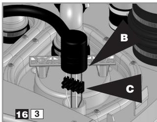
Desfaceți colierul **B**. Deșurubați și apoi scoateți firele motorului din conectorul **C**.
