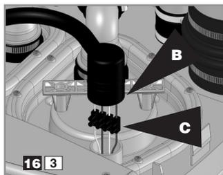
Despertar a abraçadeira **B**. Desligar os fios dos motores do dominó **C**.
