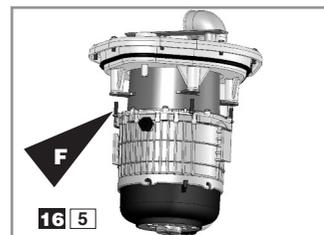
Si el motor defectuoso debe ser enviado al fabricante, es posible dejar el aparato funcionando con un sólo motor. Retirar los tornillos **F** del motor defectuoso de la trampilla.
