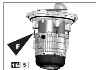
Indien de defecte motor terug moet naar de fabrikant, kunt u de fecaliënvermaler/vuilwaterpomp op minimaal niveau laten werken met één motor. Draai de schroeven **F** van de defecte motor los.
