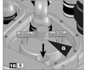
Zet de kap terug op zijn plaats. Sluit de afvoer weer aan. Gebruik de dop **G** om de uitgang van de motorbedrading van het deksel te dicht. Bevestig de slangklem **B**.
