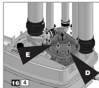
Вывинтить винты **D** люка. Осторожно поднять мотор с помощью рукоятки **E**.
