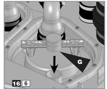
Remettre la trappe en position. Reconnecter l'évacuation. Utiliser le bouchon **G** pour obstruer la sortie des fils moteur de la trappe. Fixer avec le collier **B**.
