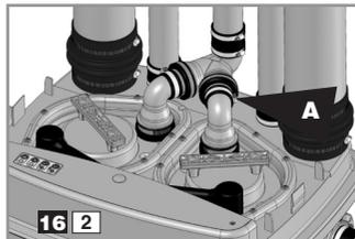
Retirar a carenagem. Desapertar a abraçadeira **A** do motor defeituoso (a válvula anti-retorno fica nesta posição durante a reparação do motor).
