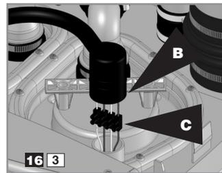
Lossa slangklämma **B**. Koppla bort motoranslutningarna från kopplingsplint **C**.
