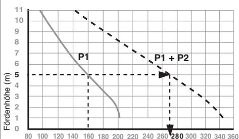
**Beispiel:** Pumpe P1 arbeitet "normal". Bei 5 m Höhe werden 160 l/min gefördert. Bei Leistungsabfall von Pumpe P1, oder plötzlich höherem Abwassereinflauf springt P2 ein. Die Förderleistung steigt auf ca. 275 l/min, bis zum Wiedereintritt des Normalbetriebs. Der Zwischenfall wird auf dem Tastenfeld angezeigt, und an den Betriebsmelder [HF-Empfänger] weitergeleitet.
