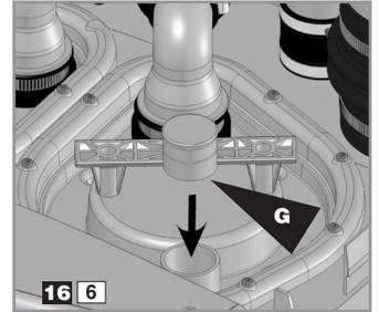
Вновь установить люк. Вновь подключить отвод. С помощью пробки **G** перекрыть выход проводов мотора из люка. Закрепить с помощью хомута **B**.
