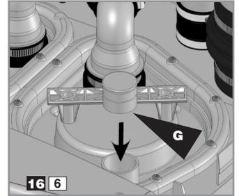
Colocar de nuevo la trampilla. Conectar de nuevo la evacuación. Utilizar el tapón **G** para obstruir la salida de los hilos del motor de la trampilla. Fijar con la abrazadera **B**.
