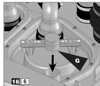
Puneți la loc capacul pe poziție. Reconectați evacuarea. Utilizați bușonul **G** pentru a obtura orificiul prevăzut pentru ieșirea firelor motorului prin capacul suport. Fixați cu colierul **B**.
