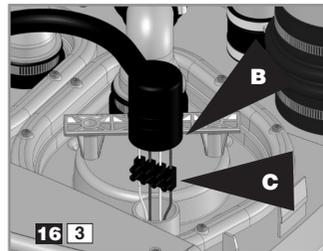
Odkręć pierścień **B**. Odłącz przewody silnika od kostki **C**.
